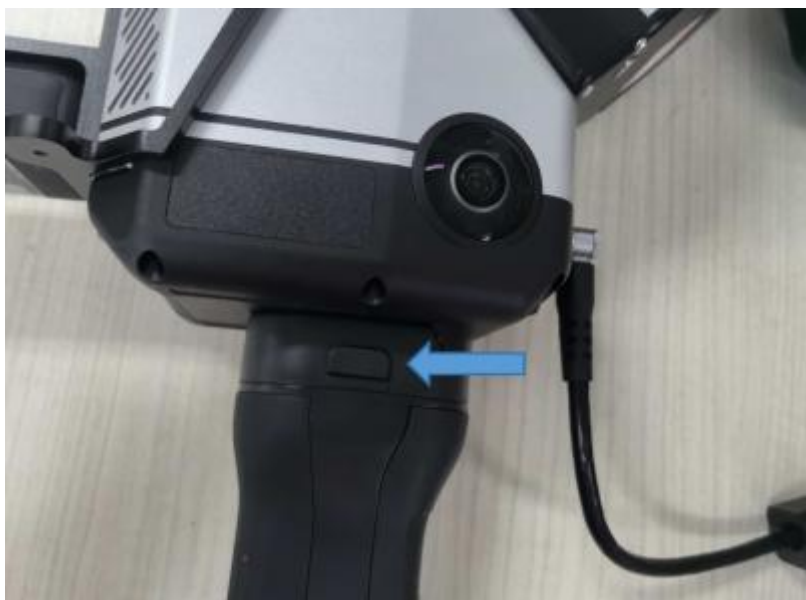
图 2-6 手柄电池与设备的安装
